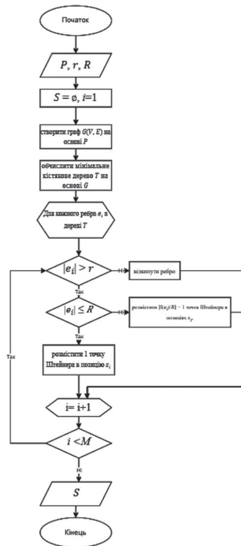
Рис. 2. Блок-схема наявного алгоритму розміщення нових БПЛА без урахування переміщення наявних БПЛА
